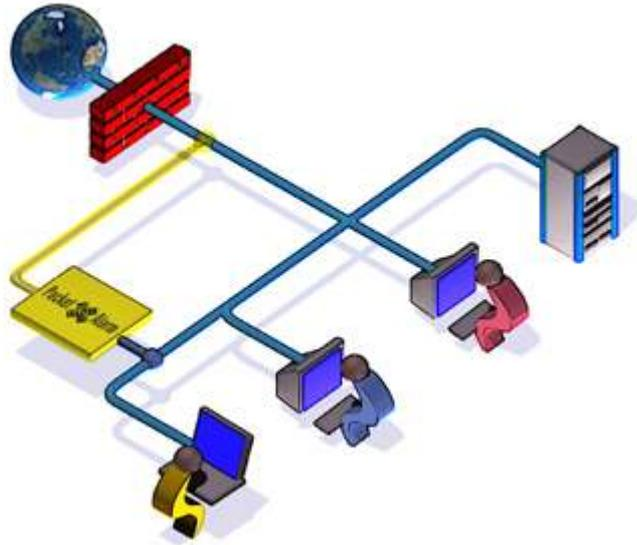
Im Sniffing Modus lauscht Packet Alarm am Netzwerk und liest alle vorbeifließenden Daten mit. Alle Attacken werden aufgezeichnet und können alarmiert werden. Wird das Prevention System aktiviert, werden Angriffe mittels TCP Reset oder einem Firewall-Hardening verhindert. Um auch ein Firewall-Hardening mit den Systemen anderer Hersteller oder mit selbstentwickelten Systemen zu ermöglichen, wird über eine spezielle Schnittstellen Definition, der Open PacketAlarm Architecture (OPA), kommuniziert.
